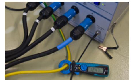
Abb. 4: Erdleiter-Strommessung (Quelle: SCHURTER AG)
