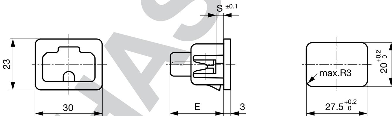
E: Lötanschlüsse: 22.5 mm
