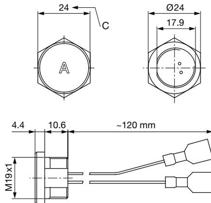
Anschluss: Flachsteckhülse Ultrafast rot 6,3 x 0,8
