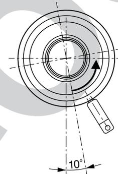
Blende mit Hilfe des Werkzeuges 10° gegen den Uhrzeiger drehen
