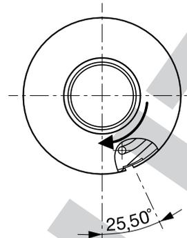
Blende im Uhrzeigersinn drehen bis diese einrastet
