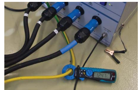
图4: 测量接地导线电流 (资料来源: SCHURTER公司)
