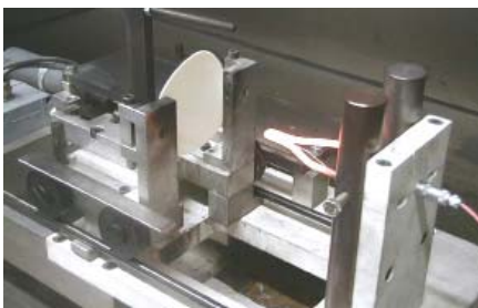
图3: 灼热丝试验设置
